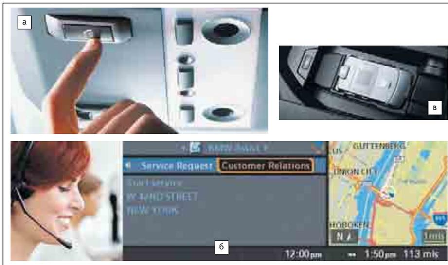
Рис. 4. Телематическая система BMW Assist: а) внешний вид и размещение в автомобиле; б) работа системы TeleService; в) громкая связь Hands Free Calling посредством Bluetooth-совместимого телефона
