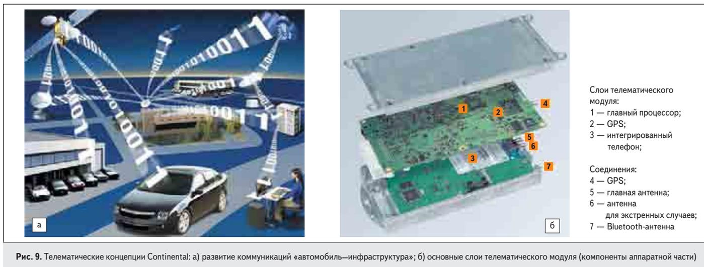
Рис. 9. Телематические концепции Continental: а) развитие коммуникаций «автомобиль—инфраструктура»; б) основные слои телематического модуля (компоненты аппаратной части)
