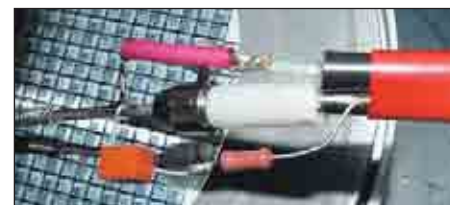
Рис. 2. Расположение RC-фильтра на зондодержателе
