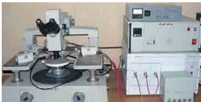
Рис. 1. Измерительный комплекс, включающий ИППП-1 и ЭМ-6040
