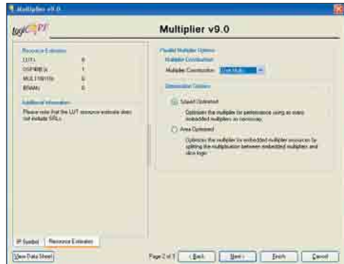
Рис. 65. Вид второй диалоговой панели «мастера» настройки параметров ядра Multiplier Generator версии v9.0 при создании параллельных умножителей
