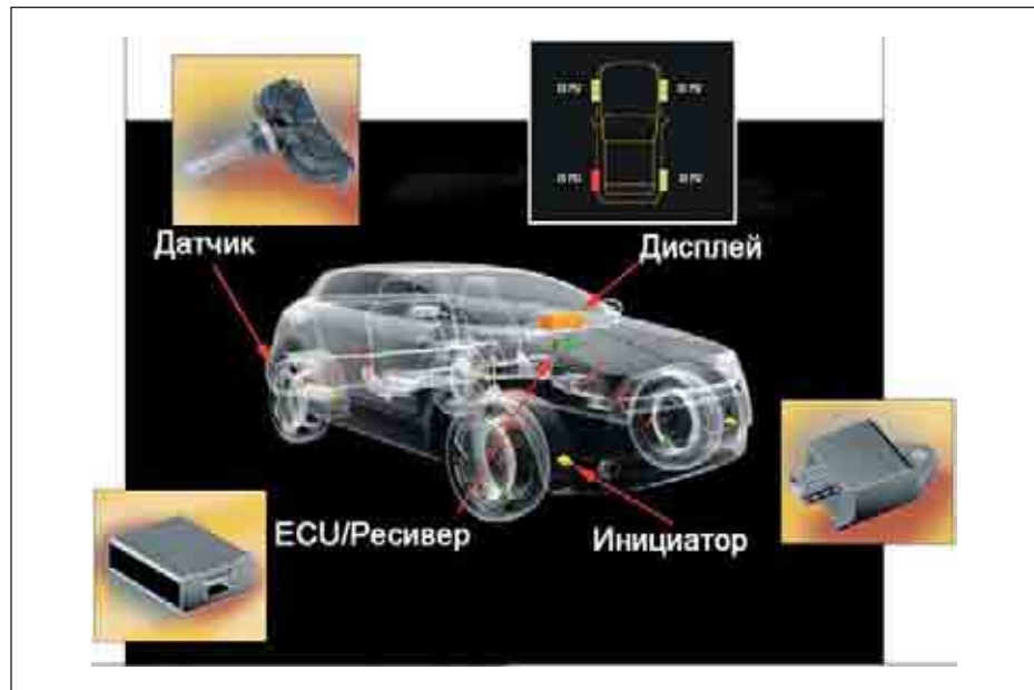
Рис. 83. Иллюстрация работы системы прямого мониторинга TPM от EnTire Solutions
