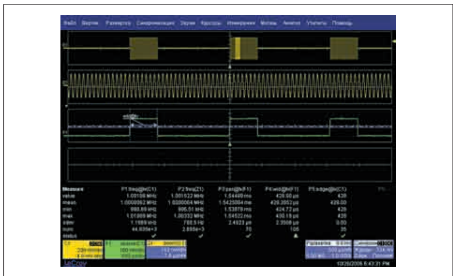
Рис. 8. Измерение временных параметров радиоимпульса: осциллограмма C1 — осциллограмма исходного сигнала, осциллограмма Z1 — растяжка одного пакета исходного сигнала, осциллограмма F1 — результат математической обработки функции «прореживание».
