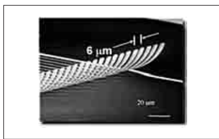
Рис. 4. Массив консольных пружинящих контактов ClawConnect с шагом 6 мкм
