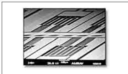
Рис. 17. Интегральная лазерная печатающая головка — комбинация на одной подложке линейки лазеров и линз
