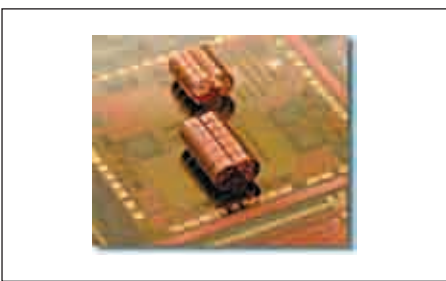
Рис. 18. Объемная MEMS-индуктивность, сформированная на поверхности кристалла микросхемы
