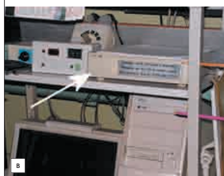
Рис. 20. Система сбора для поверки газовых счетчиков в организации «Моспромгаз». Стрелками показано УСО в корпусе от выносного привода CD. Эксплуатируется с 1995 г.
