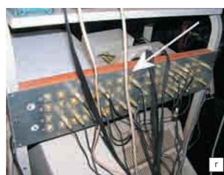
Рис. 20. Система сбора для поверки газовых счетчиков в организации «Моспромгаз». Стрелками показано УСО в корпусе от выносного привода CD. Эксплуатируется с 1995 г.
