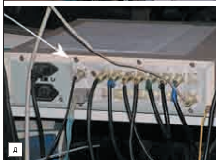
Рис. 19. Система сбора для поверки газовых счетчиков в ООО «НПФ КИП-контроль» (Москва). Стрелками показано УСО в компьютерном корпусе типа Slim. Эксплуатируется с 2000 г.
