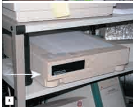
Рис. 20. Система сбора для поверки газовых счетчиков в организации «Моспромгаз». Стрелками показано УСО в корпусе от выносного привода CD. Эксплуатируется с 1995 г.
