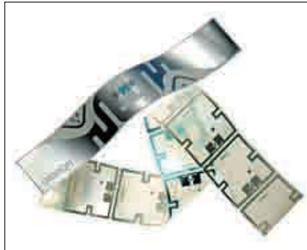
Рис. 1. Радиочастотные метки компании Omron, изготовленные по технологии JOMFUL
