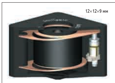
Рис. 7. Модель объектива с приводом SQUIGGLE для камеры, встроенной в сотовый телефон
