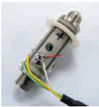
Рис. 10. Исполнение пьезопривода для работы при температурах от комнатной до 4 К (жидкий гелий)
