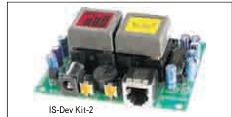
Рис. 10. Демонстрационное устройство программирования двух LCD-переключателей с красно-зеленой подсветкой
