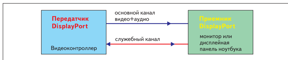
Рис. 4. Структура соединений интерфейса DisplayPort
