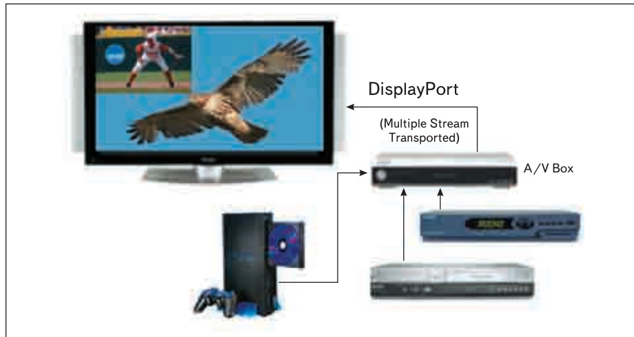
Рис. 10. Через один порт DisplayPort можно передавать информацию для нескольких приемников видео- и аудиосигналов одновременно. Это позволит упростить реализацию соединений блочной видеоаппаратуры
