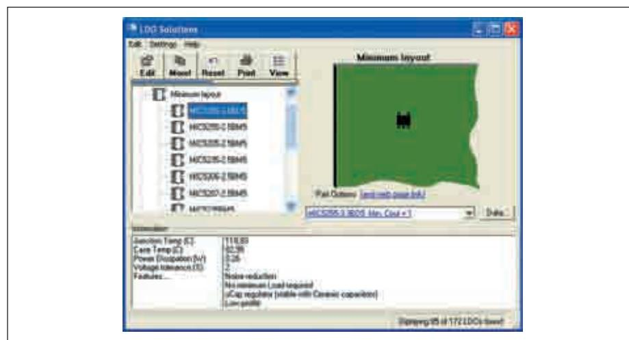
Рис. 7. Окно с результатами выбора микросхемы для проекта пользователя
