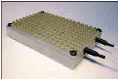
Рис. 5. Внешний вид транспондера MTR0015
