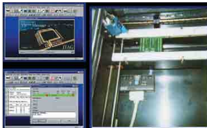
Рис. 7. Реализация возможностей Boundary Scan в тестере S40 Pilot
