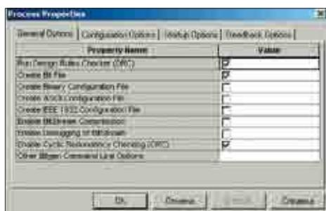
Рис. 5. Диалоговая панель параметров процесса генерации конфигурационной последовательности (вкладка **General Options**)
