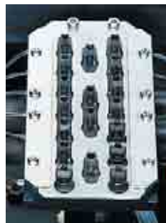
Рис. 7. Станция смены вакуумных захватов
