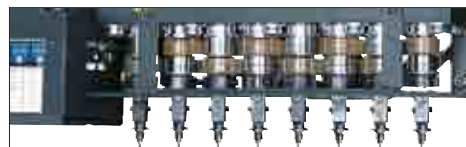
Рис. 5. Портал, оснащенный восемью установочными головками SF
