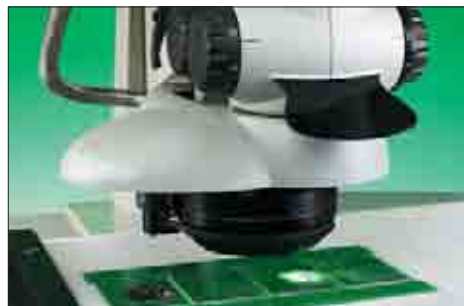
Рис. 6. Проекционная система с изменяемыми углами зрения и обзора
