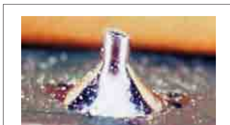
Рис. 4. Соли металлов на поверхности паяных соединений
