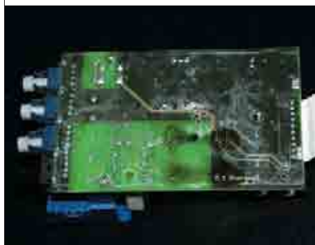
б) «Белый налет» возникающий в результате отмывки остатков флюса после пайки волной припоя
