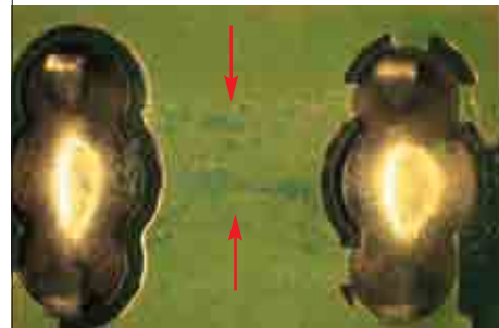
в) Область возникновения токов утечки Рис. 8
