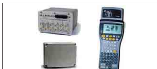
Рис. 1. Конструктивные исполнения считывателей RFID
