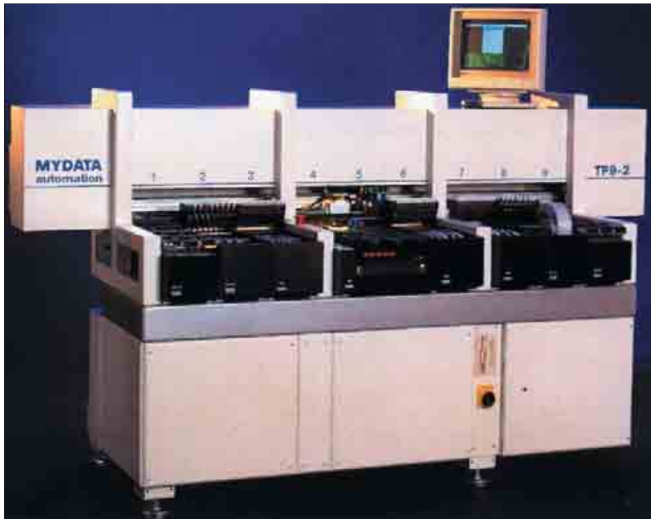
Рис. 5. Машина фирмы MYDATA для установки SMD-компонентов с производительностью 4,8 тыс. компонентов в час
