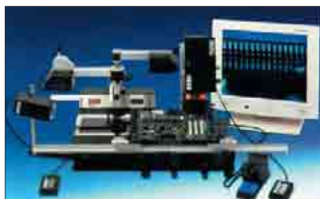
Рис. 10. ИК-нагрев с контролем температуры зоны пайки
