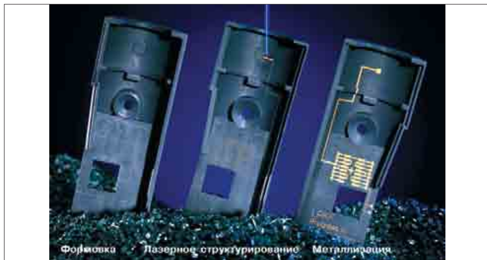
Рис. 13. Три стадии производства трехмерной проводящей структуры
