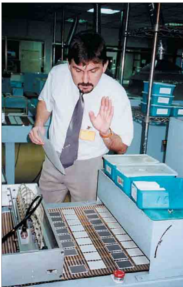
Тайвань. Фабрика корпорации «Yageo» в Каошунге. Входной контроль японских керамических пластин, из которых изготавливают резисторы 0603 и 0402
