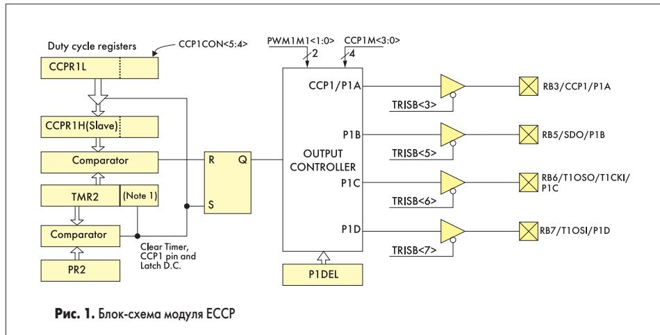
Рис. 1. Блок-схема модуля CCP
