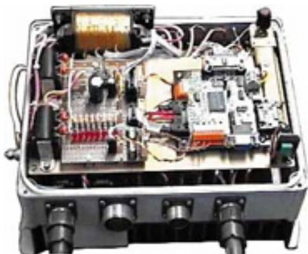
**Рис. 2.** Опытный образец преобразователя частоты «Универсал-1,5» с системой управления на базе TMS320F241 в составе контроллера МК10.1
