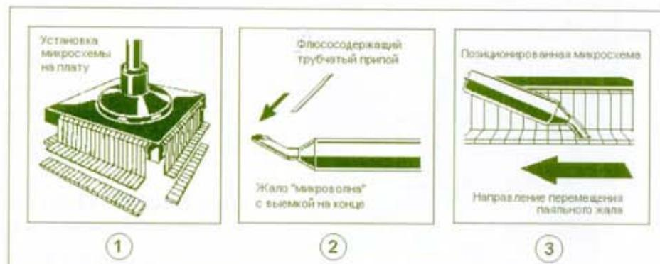
Рис. 6. Быстрая пайка корпусов QFP с малым шагом при помощи жала «микроволна»
