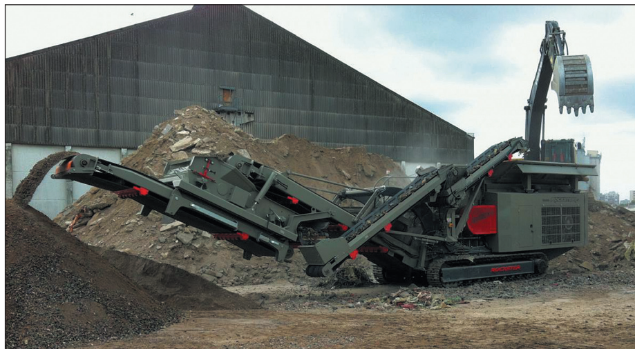
Рис. 7. Параллельная гибридная камнедробилка ROCKSTER
