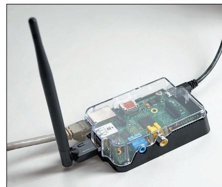
Рис. 5. Raspberry Pi как беспроводная точка доступа
