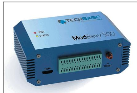
Рис. 11. Промышленный компьютер ModBerry 500 на базе Raspberry Pi
