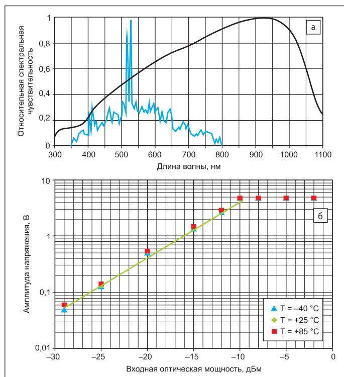
Рис. 5. Характеристики фотоприемника: а) спектральная характеристика фотодиода; б) зависимость амплитуды выходного сигнала от мощности оптического излучения
