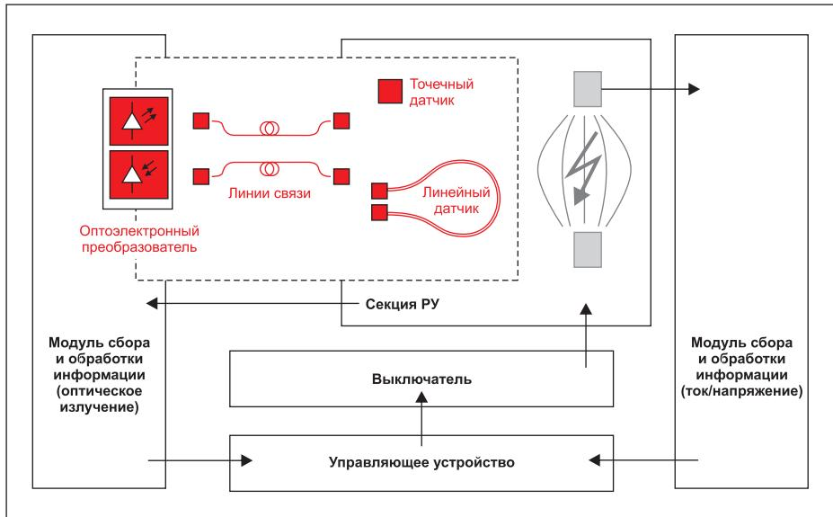
Рис. 3. Блок-схема системы ЗДЗ на основе МТЗ и оптического датчика
