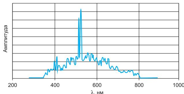
**Рис. 2.** Спектр оптического излучения вспышки электрической дуги
