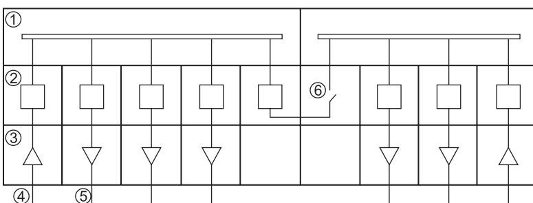
Рис. 1. Схема КРУ (на примере двухтрансформаторной подстанции):
