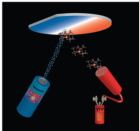
Рис. 2. Покрытие 3-дюймовой сапфировой пластины атомами ванадия (синий) и молекулами, содержащими диоксид ванадия (IV) (оранжевый)
