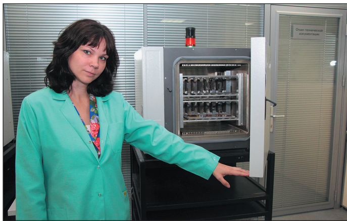
Здесь электронные комплектующие испытывают на долговечность
