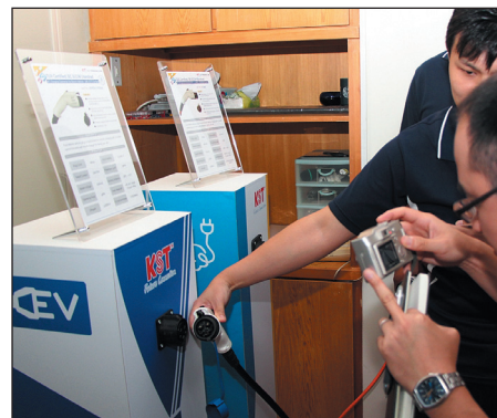
В компании K. S. TERMINALS. Терминалы для быстрой зарядки электромобилей, оснащенные коннекторами KST
