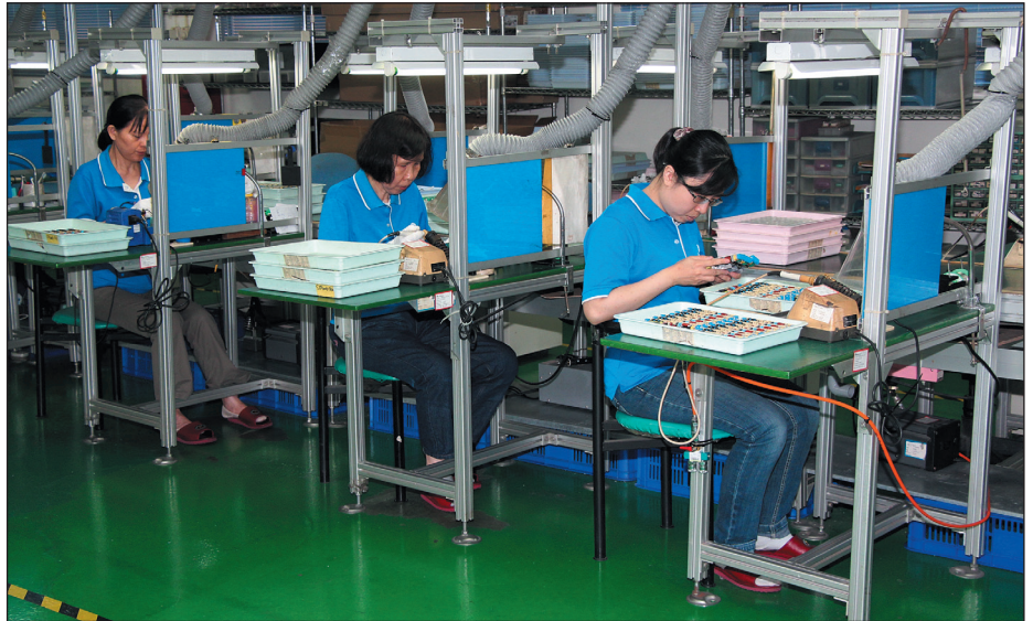
Завод OmniTronix. Визуальный контроль готовых плат
