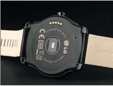
Рис. 12. Нижняя плоскость смарт-часов LG с вмонтированным датчиком пульса
