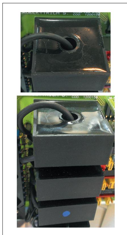
**Рис. 7.** Трансформаторы тока капсулированной конструкции с вторичной обмоткой, заложенной в пластмассовый корпус и залитой эпоксидным компаундом, отвержденным под вакуумом. Видна первичная обмотка, состоящая из одного витка гибкого изолированного провода
