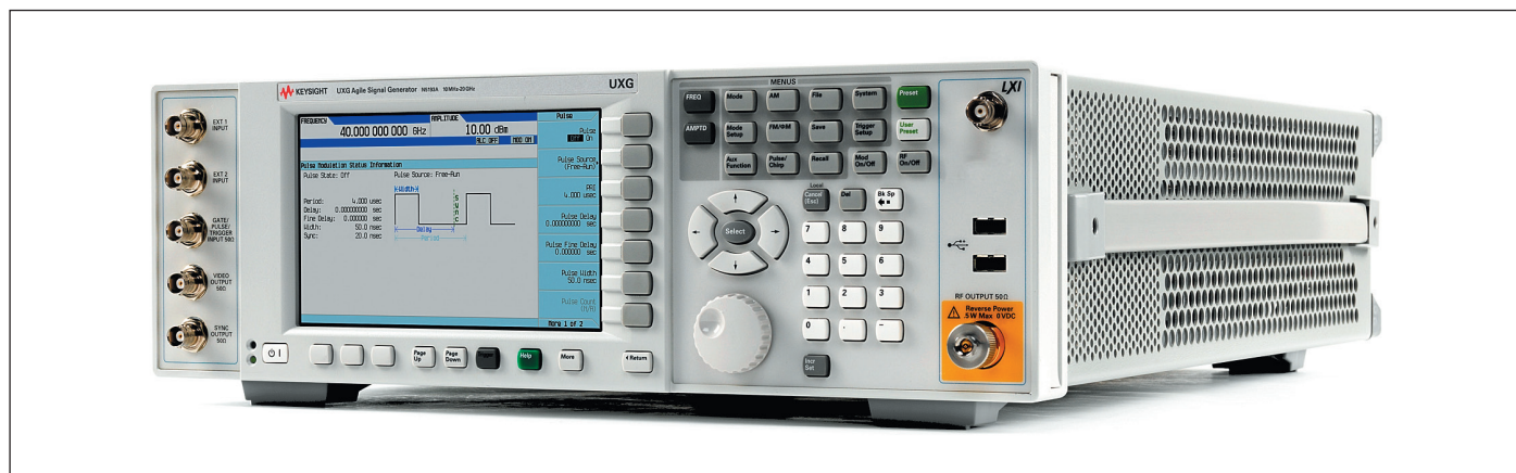
Рис. 3. Серийный быстроперестраиваемый генератор сигналов Keysight UXG является мощным компонентом, который можно использовать в качестве независимого гетеродина или масштабируемого имитатора излучателей
