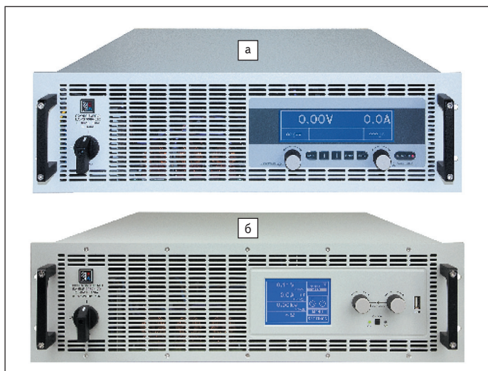
Рис. 1. Оборудование для испытаний: а) PS 9080-1703U — программируемый источник питания; б) ELR 9080-170 — электронная нагрузка с рекуперацией
