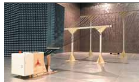
Рис. 11. Испытательный стенд, производимый на продажу компанией Montena Technology для лабораторных испытаний (слева виден генератор импульсов, справа — антенная система)
