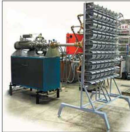
Рис. 5. Генератор ультраширокополосных импульсов с пиковой излучаемой мощностью 3,4 ГВт, разработанный ИСЭ СО РАН
