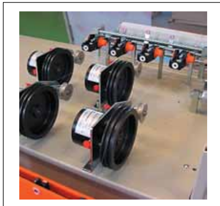
Рис. 8. Обеспечение постоянного момента подачи нити
