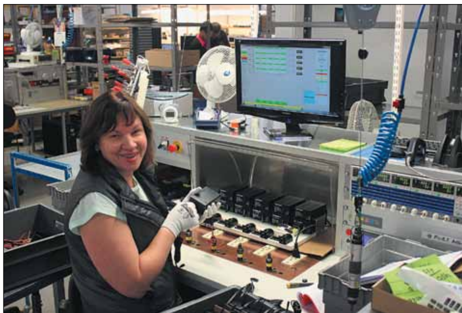
Рис. 3. Диагностика источников питания на компьютерном стенде
