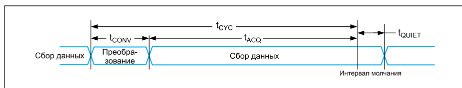
Рис. 1. Простая последовательность преобразования и передачи данных в АЦП
