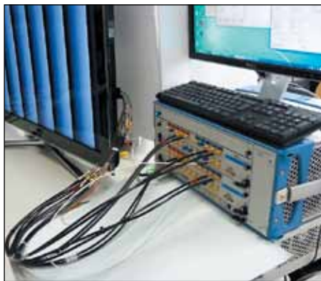
Рис. 5. Схема тестирования приемника с помощью генератора сигналов произвольной формы
