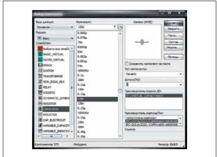
Рис. 6. Настройка в окне «Выбор компонента» параметров конденсатора для последующего его размещения на схеме
