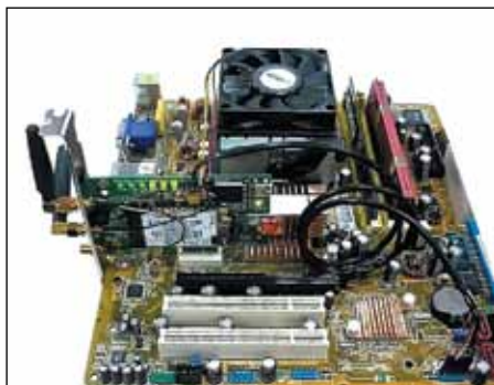
Рис. 3. Модули AirPrime MC можно легко интегрировать в любые устройства, имеющие слот PCI Express Mini Card
