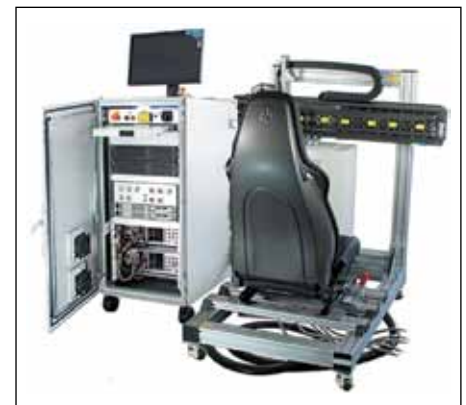
Рис. 4. Стенд комплексного тестирования электроприводов автомобильного кресла
