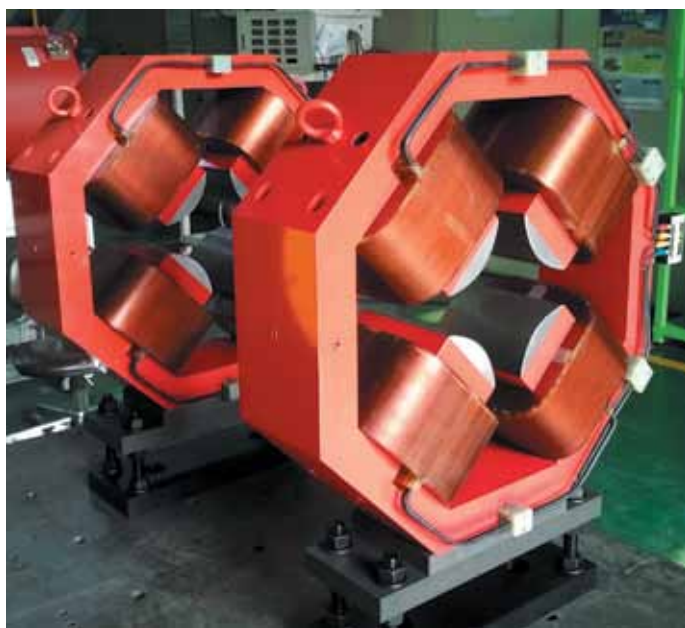
Рис. 6. Пример 4-полюсного электромагнита, применяемого в транспортном канале линейного ускорителя
