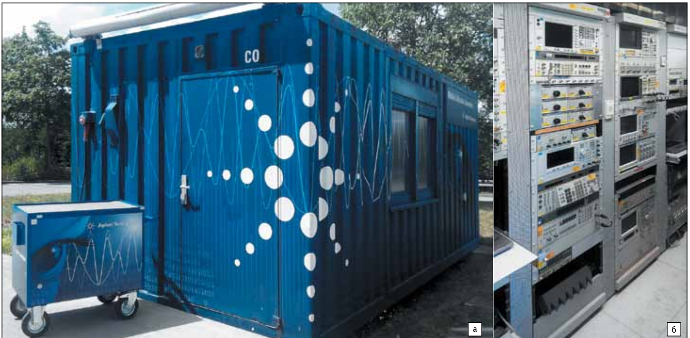
Рис. 6. Voscalt — перемещаемая калибровочная лаборатория (а) и вид ее внутри (б)
