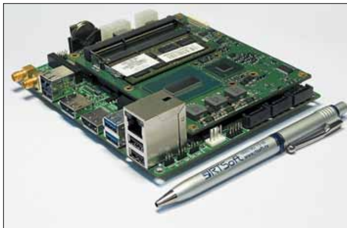
Рис. 7. Пример собственной разработки дизайн-центра «РТСофт» — многофункциональная платформа «Кена»
