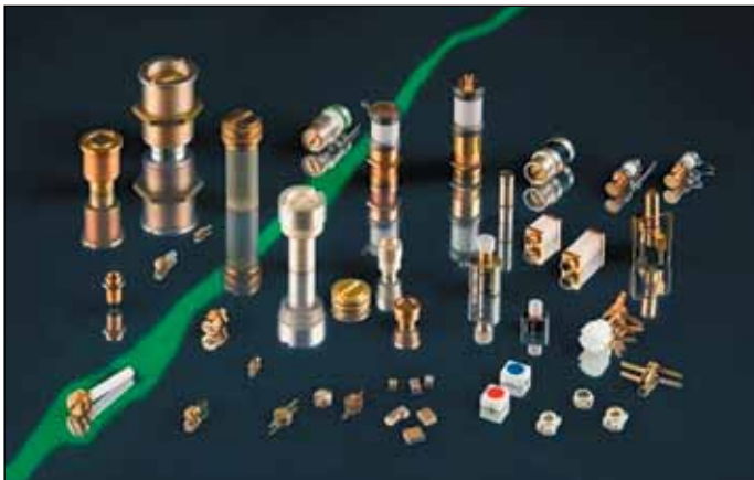
Рис. 1. Подстроечные конденсаторы с воздушным и твердым диэлектриком [1]
