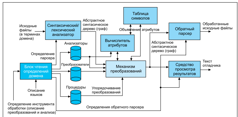
Рис. 2. Схема реализации системы преобразования кода DMS
