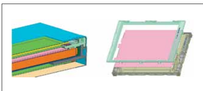
Рис. 7. Конструкция вибростойких дисплейных панелей для промышленного сектора
