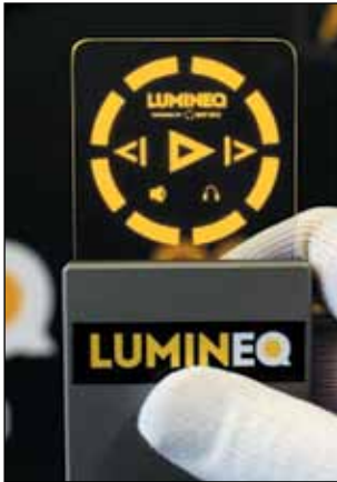
Рис. 11. Пульт управления с внекорпусным прозрачным дисплеем
