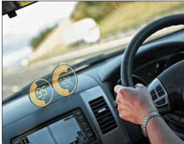
Рис. 12. Автомобильный HeadUp-дисплей на базе прозрачной электролюминесцентной панели Lumineq
