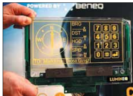
Рис. 8. Прозрачная люминесцентная панель ELT256.120.90 со схемами управления и встроенным контроллером
