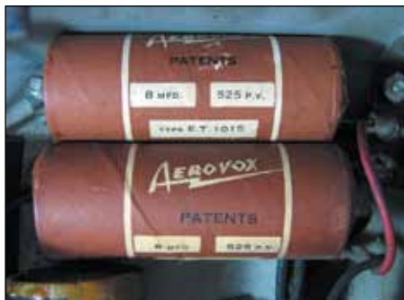
Рис. 2. Два электролитических конденсатора 1930-х годов (8 мкФ, 525 В) (источник: Ozguy89, English language Wikipedia)
